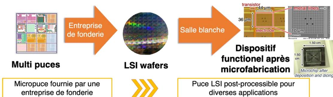
Figure : Microfabrication sur un système LSI-CMOS pour des applications bioélectrochimiques
